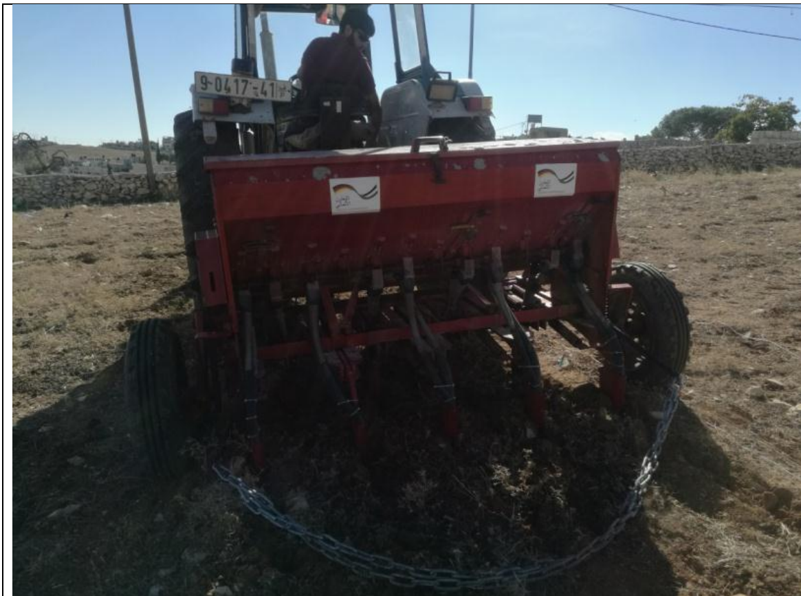
Fig. 3.5. Conservation tillage sowing machine.
